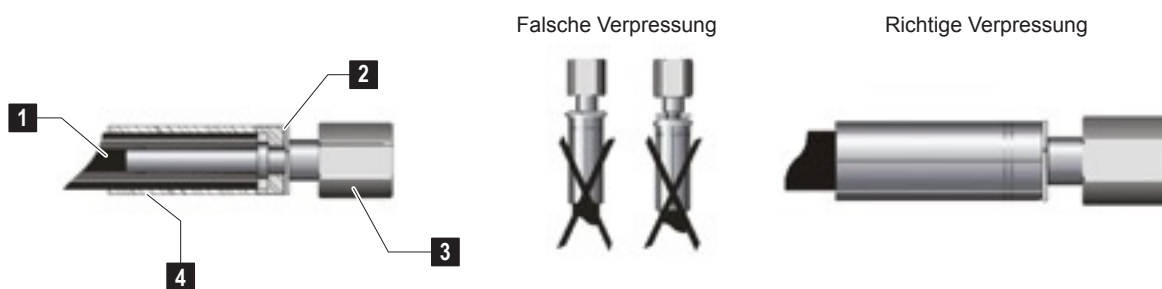
Abb. 20: Verpressung der Hochdruckschläuche
